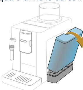
*Inclina il serbatoio verso l'esterno: una volta sganciato, si estraе facilmente.*
