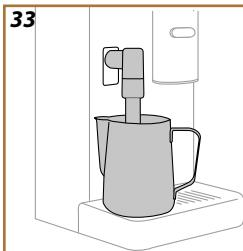
4. Spingi in basso la ghiera nera della lancia vapore in posizione "FOAM" (Schiuma) (fig. 32);
